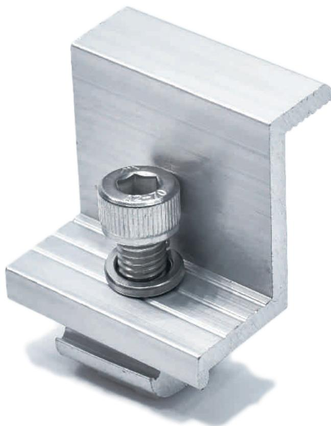
Las abrazaderas END de 35mm están diseñadas en la base del riel 7R para fijar el módulo en el extremo del riel, están disponibles módulos de 30 mm a 55 mm de espesor.
