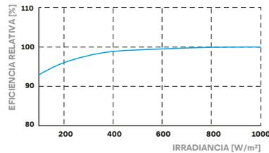
Típica potencia del módulo en condiciones de irradiación bajas en comparación con las condiciones STC (25°C, 1000 W/m<sup>2</sup>).
